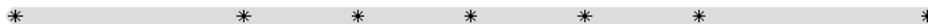
Figur 16. Vid beräkning av maximalnivå från spårtrafik i Nord2000 används en linjekälla för att representera tåget. Linjekällan (grå) modelleras med punktkällor (svarta stjärnor) som placeras ut vid tågets mitt, \pm l_p/2 , \pm l_p/4 och \pm l_p/8 , där l_p är linjekällans längd.
